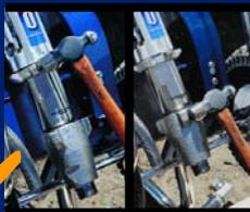
Можно легко снять узел насоса Endurance™ и впускной клапан QuickAccess™, не покидая рабочую площадку!
